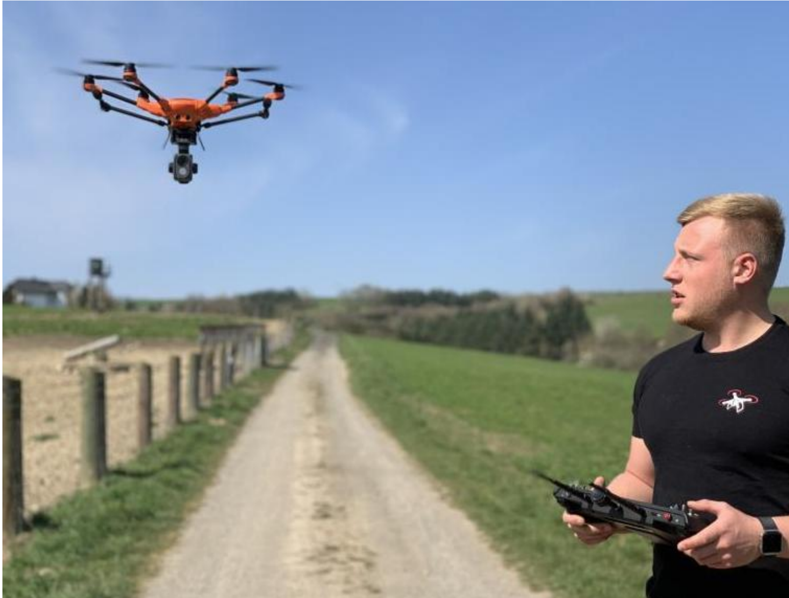
Alexander Mohr hat seine mit einer Wärmebildkamera ausgerüstete Drohne gestartet. Das hochsensible Gerät fliegt in einer Durchschnittshöhe von 25 bis 30 Metern die Wiesenflächen ab – stets auf der Suche nach Rehkitzen, Junghasen oder am Boden brütenden Vögel.
