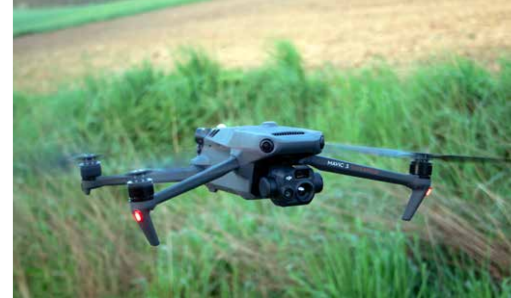
Die DJI „Mavic 3 Enterprise“ oder andere hochwertige Copter operieren gleichzeitig mit Wärme- und Echtbildkamera.
